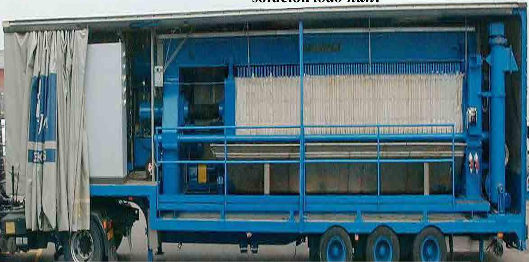
➤ **Planta fixa e móvil de secado de lodos para garantir un procesado e produción continua.**
