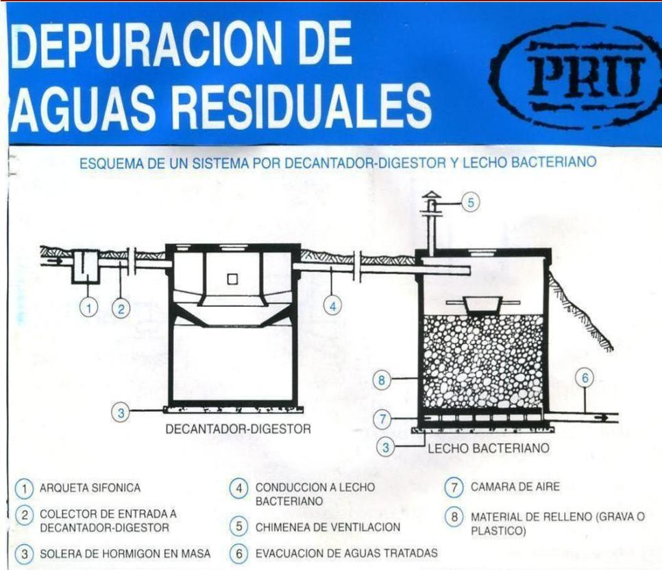
Esquema de un decantador-digestor y lecho bacteriano para depuración de aguas residuales domésticas en el medio rural gallego
