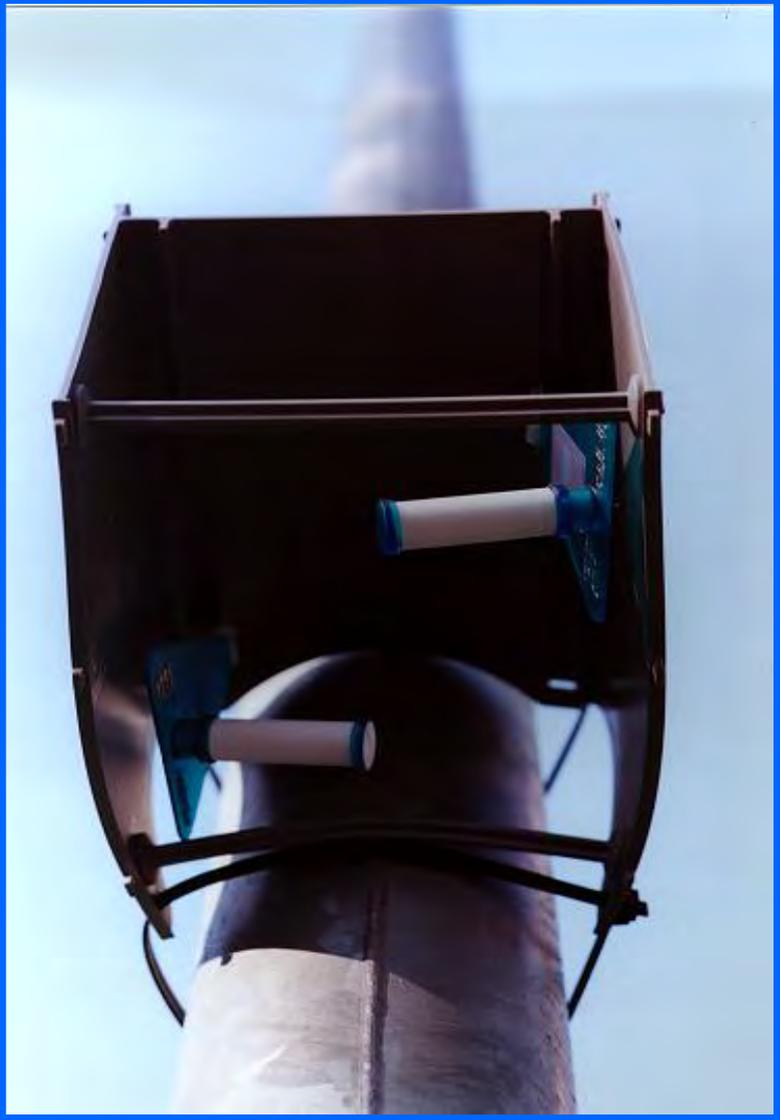
**Para el análisis de  $\text{NO}_2$ , el cartucho ubicado en el interior se encuentra impregnado de trietanolamina. Sin embargo, para benceno se utiliza carbón activo o grafitizado, dependiendo de la desorción posterior.**
