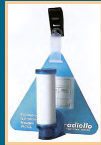
**El NO<sub>2</sub> se determina mediante la reacción Griess-Saltzman y se analiza mediante espectrofotometría UV-VIS  $\lambda=540$  nm**
